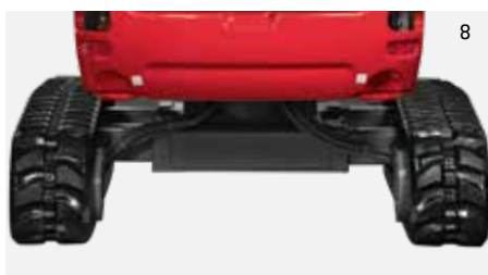
LARGEUR DU TRAIN DE ROULEMENT DÉPLOYÉ 1500 MM
