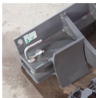
Dozerblad handmatig te verbreden
